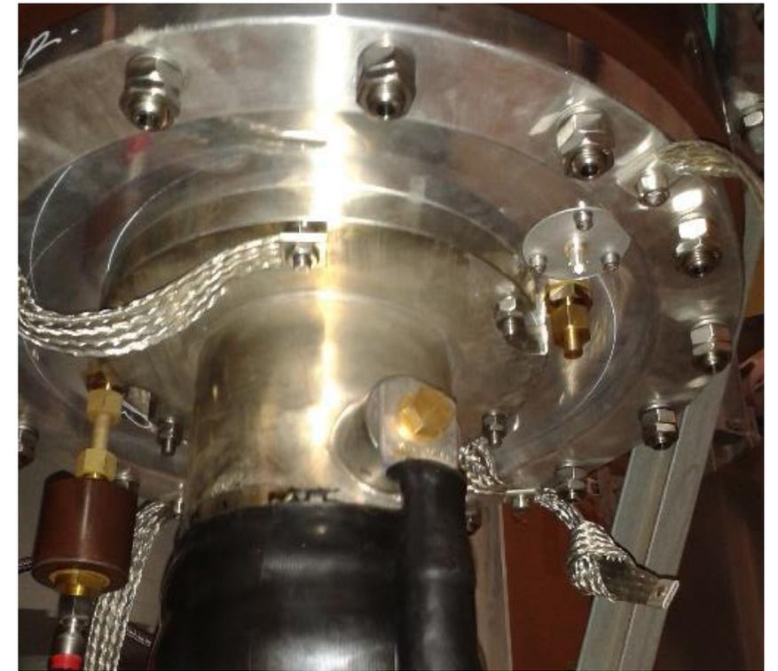
**Sensor integrado:** el fabricante del cable puede proporcionar accesorios de A.T. con sensores de DP integrados según las especificaciones del cliente para que se conecten directamente al instrumento/osciloscopio para los registros de DP.
