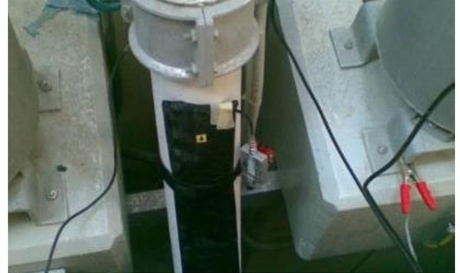
Antena UHF: puede detectar actividades de descargas parciales que se producen en la terminación de cables GIS mediante la captación de señales UHF.
