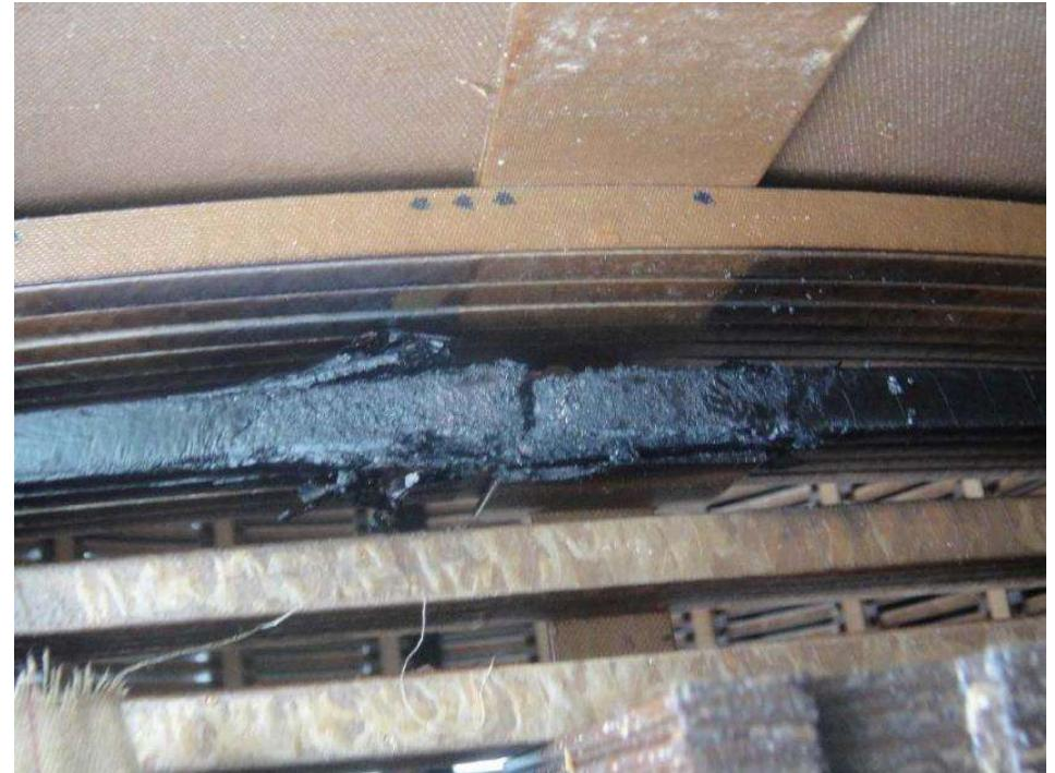
发现产气的根本原因是从 C 相公共绕组顶部开始的第 73 个圆盘中的导体被腐蚀。这还没有发展成匝间短路。
