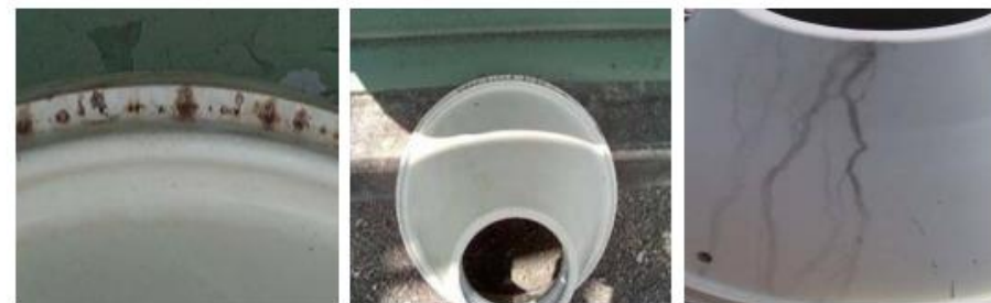
图B.2 GIS 绝缘支柱绝缘子上放电痕迹
